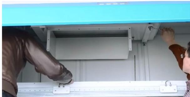
k) Remove the fan bolts, remove the fan box
